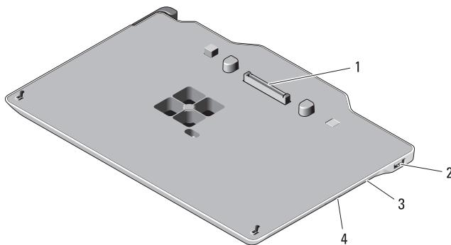
1 conector de acoplamento
